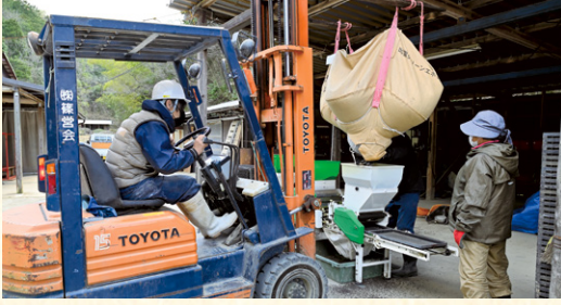
500kgの土をフレコンで播種機へ運びます。
