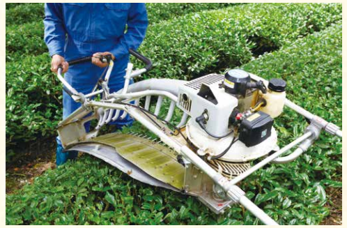
乗用型摘採機が使えない斜面で活躍するのが可搬式摘採機。機械の両端を2人で持って動かします。
