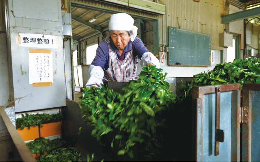
収穫された茶葉は町内の製造工場加工されます。写真は、茶葉を乾燥させるためにベルトコンベヤーでコンテナへ運ぶ作業のようす。
